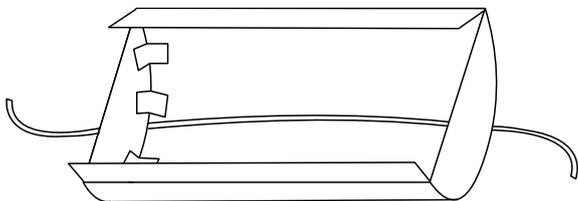
アーチ (A) とフタの側面 (B) のスキマから、長さ1.5mのひもを通し、一周させて結びます。
